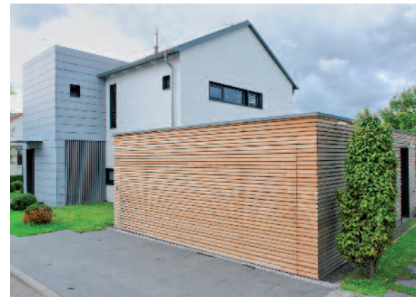
Flächenbündiges Kipptor mit Profil-Schalung aus Lärchenholz
