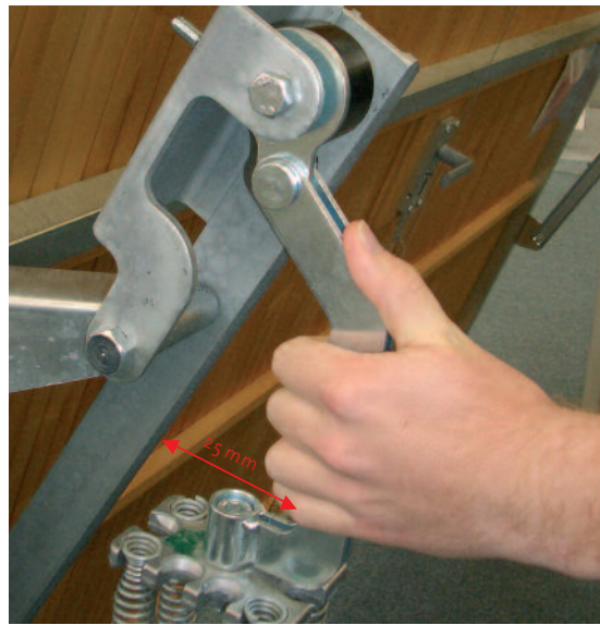
Für mehr Sicherheit - Mindestabstand von 25 mm zwischen den Tragarmen
