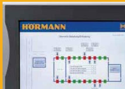
Kontrollierte Abläufe durch Visualisierung über ein Bedienpaneel oder eine Web-Applikation
