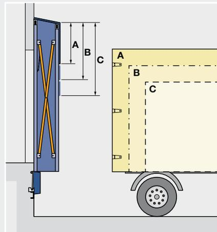
Stimmen Sie die Höhe der Kopfplane auf die Fahrzeughöhe ab. Optimal: 150 mm Überlappung
