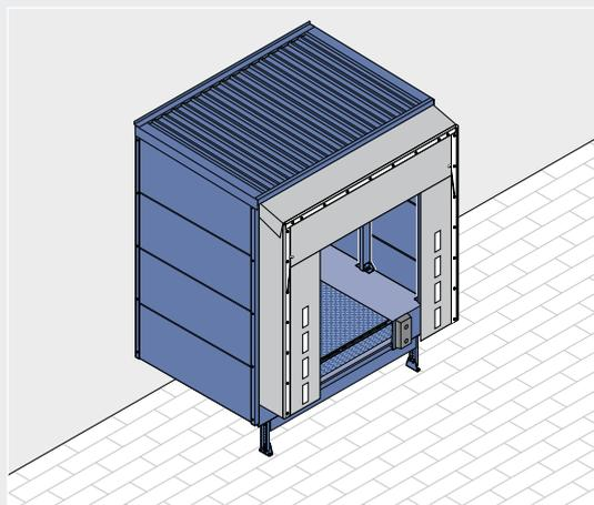
**Vorsatzschleuse LHP 2 mit 60 mm Paneelen**
