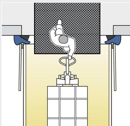
Bei Kissentorabdichtungen wird auch die Naht zwischen LKW und der aufgeschlagenen Tür abgedichtet.
