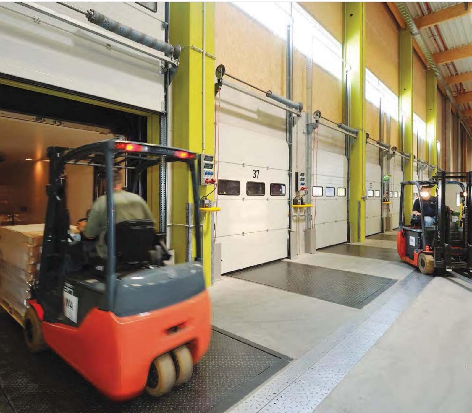
Hydraulische Ladebrücken erhalten Sie als Klappkeil- oder Vorschub-Ladebrücke. Mit einer Länge von bis zu 5 m können Sie große Höhenunterschiede vom Rampenniveau zur LKW-Ladefläche überbrücken. Dabei wird die Ladebrücken-Plattform bis zu einer Größe von 2000 × 3000 mm aus einem Stück gefertigt. Bei breiteren und längeren Ladebrücken verbindet eine sorgfältig ausgeführte Schweißnaht die Platten zu einer durchgehend stabilen Plattform.
