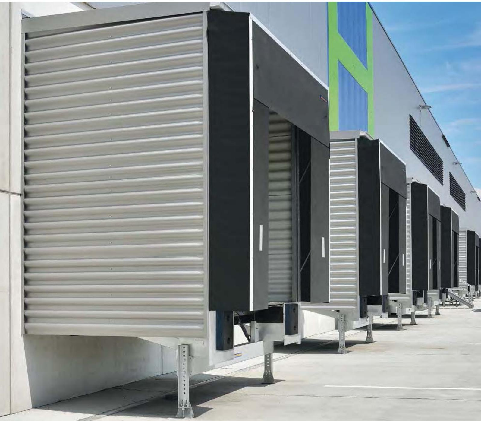
Vorsatzschleusen werden besonders energieeffizient und platzsparend vor die Halle gesetzt. So ist die Halle bis an die Außenwände voll nutzbar. Das Hallentor wird nicht auf die Ladebrücke, sondern hinter der Ladebrücke bis auf den Hallenboden geführt. So ist die Toröffnung besonders außerhalb der Verladezeit bestens isoliert. Auch für die Renovierung bieten sich Vorsatzschleusen an, da ohne Umbaumaßnahmen in der Halle eine komplette Verladestation entsteht.
