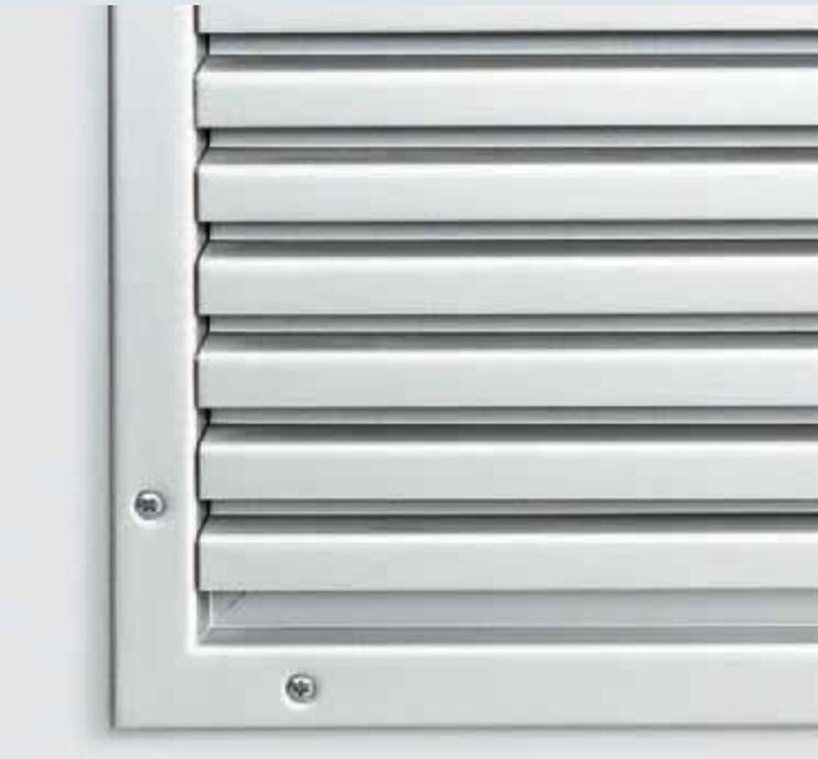
Alle Lüftungsgitter bestehen aus durchstecksicherem Stahlblech mit innenliegendem Lochblech. Sie werden verzinkt und pulvergrundbeschichtet in Grauweiß (ähnlich RAL 9002) geliefert.
